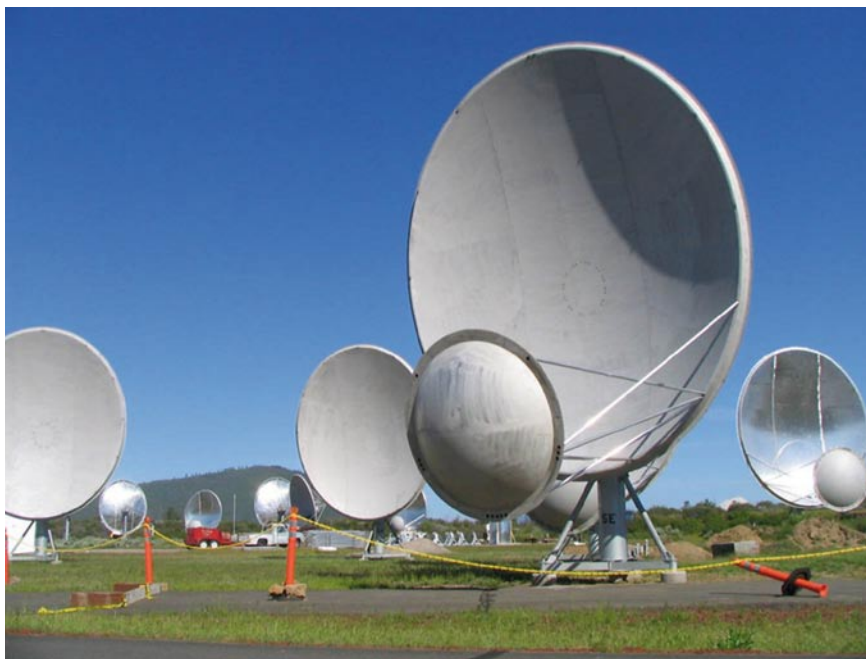
► Abb. 4: Die Antennen des Allen Telescope Array (ATA), das zur Zeit am Hat Creek Observatorium (Kalifornien) gebaut wird, bestehen aus 6-m-Parabolantennen mit seitlich versetztem Fokus. (Quelle: SETI Institute)
